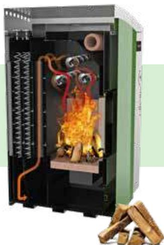
La chaudière **TITAN ADVANCE** passe automatiquement du mode **Bois** au mode **Pellet** grâce à un échangeur variable, qui garantit l'efficacité maximum dans tous les modes. Même en utilisant uniquement du pellet. En outre, à travers des actionneurs électriques la chaudière modifie automatiquement le parcours fumées et le débit de l'air comburant pour obtenir le rendement maximum. Toujours.
