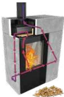
En mode pellet, le volet des fumées dévie vers l'échangeur pellet et l'extracteur des fumées, pour favoriser un rendement optimal et une combustion parfaite.
